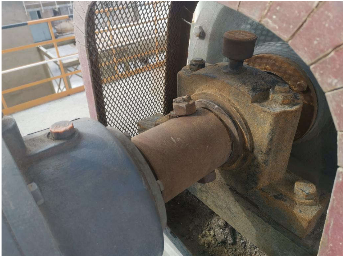
螺旋输送机传动轴固定螺栓凸出部分细节照片
